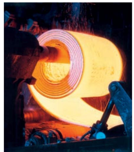
1.5.3 Bobineuse dans le train à feuillards à chaud à Bochum. Pour éviter des pertes de température préjudiciables à la qualité finale de l'acier, la bobine de tôle est enroulée avant le passage dans le train finisseur
